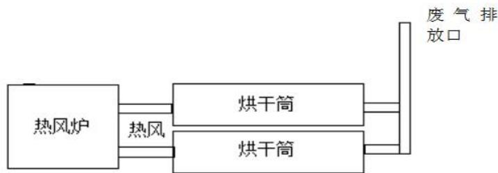
图 2-2 烘干工艺流程示意图
