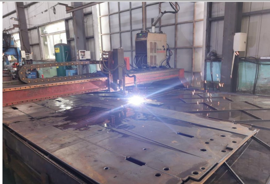
切割机及水箱除烟器
